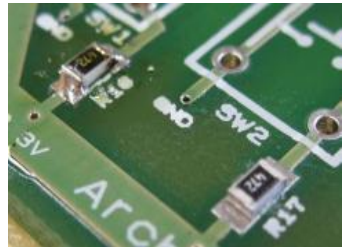
奥のチップ抵抗(R18)のはんだ付けをしたところ. 手前(R17)は固定したところ.
